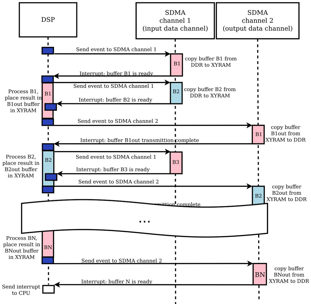
**Рисунок 4.1. Диаграмма последовательности взаимодействия DSP и SDMA**
